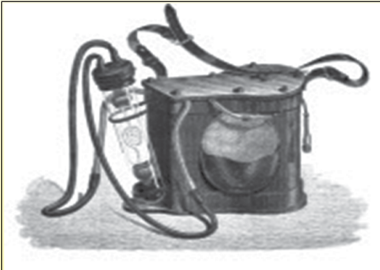
1862 Dumas et Benoît's Electrical miner lamp
